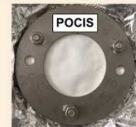
パッシブサンプリング法に使用するサンプラー
