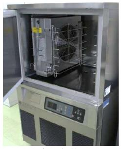
▲ HBC-6A3 (ホシザキ製) 庫内温度:最低-40℃、芯温で温度制御可、 タイマー機能、風速調整機能(4段階)
