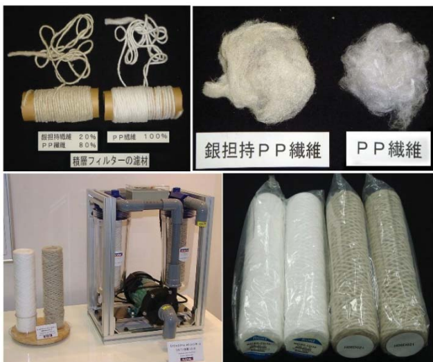
銀担持繊維 (ポリプロピレン繊維) を用いた抗菌フィルター 金井重要工業 (株) 製の抗菌フィルター、バクテクリンAg、銀担持ポリプロピレン繊維を糸巻きフィルターにしたもの。60ミクロンの孔隙があり、目詰まりが少ないフィルター。 銀による抗菌作用で高い殺菌効果が得られる (銀溶出がない)
