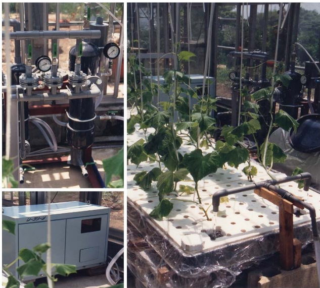
養液栽培のオゾン水循環による殺菌効果を調べた試験装置 左上：オゾン水調整装置、左下：オゾン発生装置、右：キュウリの栽培状況
