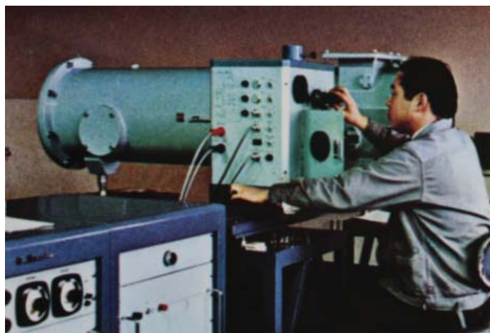
粉塵中の金属成分を測る発光分光分析装置
