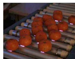
プラズマ発生状態
