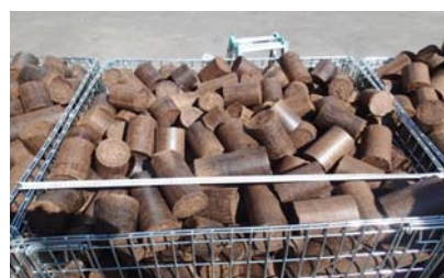
試作した木竹混合BIC
