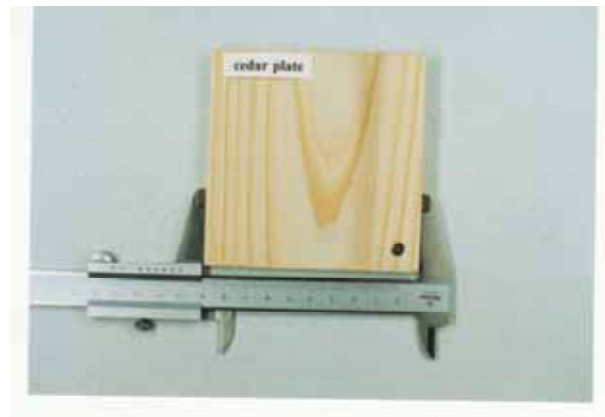
図1. スギ板暴露試験材料. スギ板(10×10×1 cm)
