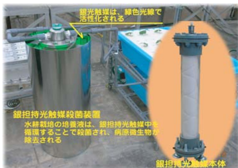
徳島大学、徳島県農業総合研究所と共同開発した、銀光触媒による養液栽培培養液殺菌装置
